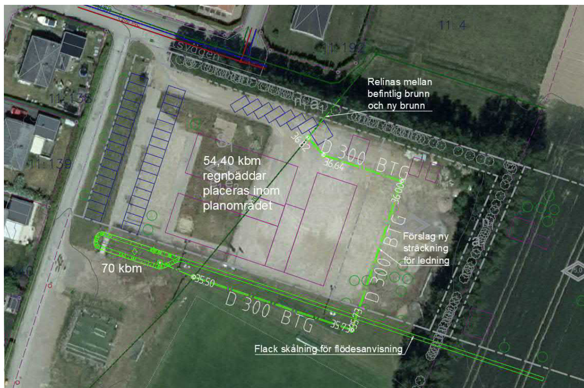
Förslag på ny sträckning för dagvattenledning samt flack skålning med dike i västra änden för hantering av 20-års regn. (Norconsult, 2022-03-14.)
